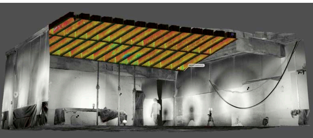
Abb. 1: Ermittlung der Auftragsmengen bei einer Rippendecke. Nur eine durchweg saubere und korrekt erfasste Oberfläche von Bauteilen funktioniert als Grundlage für eine später effiziente Bauabrechnung.
