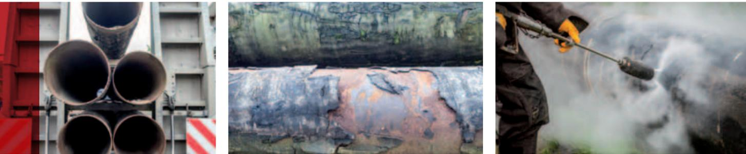
Pipeline lagert auf dem Betriebsgelände Metalle, die aufgearbeitet werden und bereitet Rohre für den Einbau vor. Mit starken Sandstrahl- und Wasserstrahlgeneratoren werden die Oberflächen gereinigt und, befreit von schadhafte Beschichtungen, vorbereitet. Polyurethan-Beschichtungen werden für den Einbau vorbereitend aufgetragen. Metalle, die nicht mehr eingebaut werden, finden im Recyclingprozess neue Verwendung.
